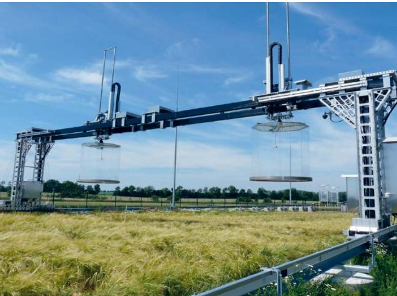
Mobiles Kransystem zur Messung von CO<sub>2</sub>-, CH<sub>4</sub>-, und N<sub>2</sub>O-Flussraten im AgroScapeLab Quillow des ZALF.
