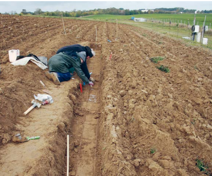
Unterirdische Tracer-Ausbringung (KBr) in einem 10 m langen Graben im gepflügten Boden quer zum Hang oberhalb von LP7 auf dem CARBOZALF-D Versuchsfeld
