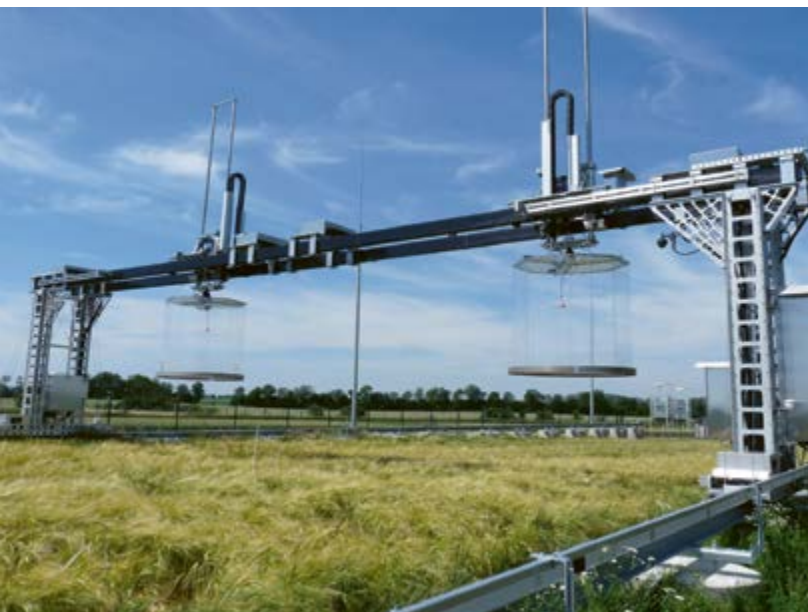
Mobiles Kransystem zur Messung von \text{CO}_2 -, \text{CH}_4 - und \text{N}_2\text{O} -Flussraten im AgroScapeLab Quillow des ZALF.
