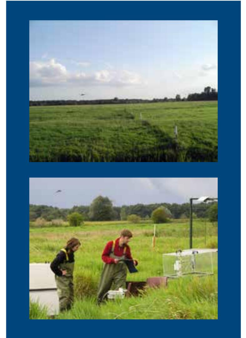
Abb. 3, oben: Havelländisches Luch nahe Paulinenaue (Brandenburg, nordwestlich von Berlin); unten: Messung der C-Gasflüsse (CO<sub>2</sub>, CH<sub>4</sub>) mithilfe der manuellen Gashaubenmethode auf Versuchsfeldern der Forschungsstation
