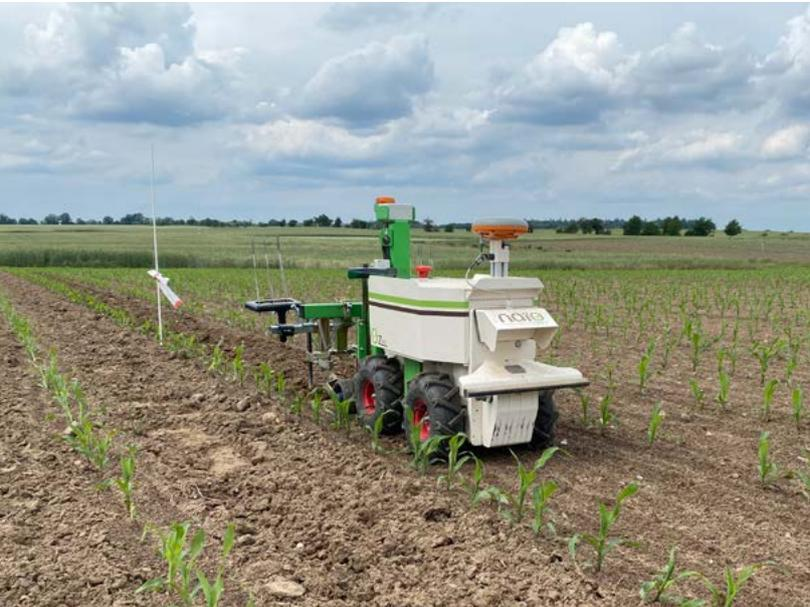
Der autonom fahrende Roboter Naio Oz übernimmt mit seinen Striegel- und Hackaggregaten die mechanische Unkrautkontrolle sowohl in als auch zwischen den Reihen des Körnermais.
