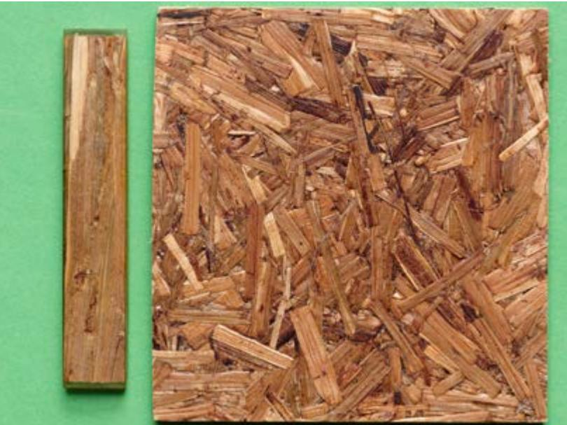
Probekörper aus mit leinölbasiertem Epoxidharz verklebten Luzernestängeln für Demonstrationszwecke und Stabilitätstests, hergestellt von der Bio-Composites and More GmbH (B. A. M.)
