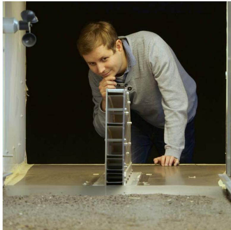
Bei Feldversuchen in Potsdam (oben) und Müncheberg (links) wurde unter anderem die Menge an Feinstaub gemessen, die während der Düngerausbringung und Bodenbearbeitung aufgewirbelt wird. Im ZALF Windkanal untersucht Steffen Münch den Einfluss des Düngers auf die Winderosion unter kontrollierten Bedingungen (unten).
