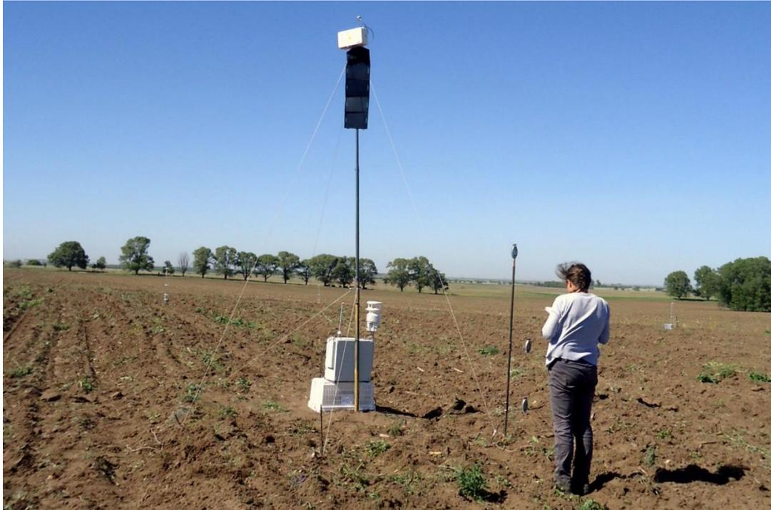
Bildunterschrift: Feldmesstechnik für die Analyse von Winderosion und Staubemissionen
