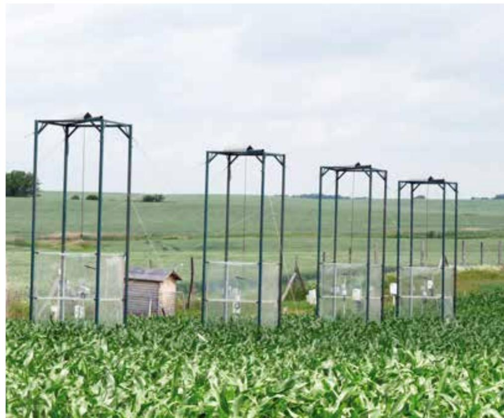
Abb. 4: Messen des Netto-CO<sub>2</sub>-Austauschs (Differenzbetrag zwischen Bruttoprimärproduktion und Ökosystematmung) auf ausgewählten Geländepositionen der CarboZALF-Experimentalfläche mit einem automatisierten Haubensystem, das je aus vier Autohauben und einer zentralen Steuereinheit besteht.
