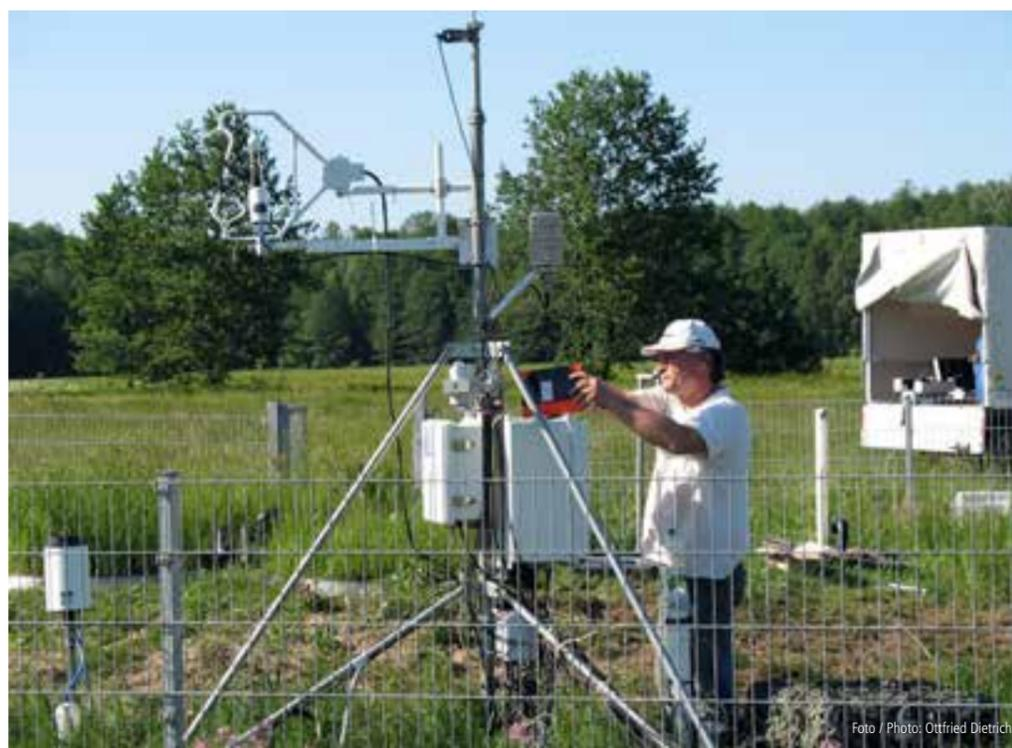
Abb. 1: Wartung der Eddy-Covariance-Anlage zur automatischen Messung der Verdunstung im Spreewald
