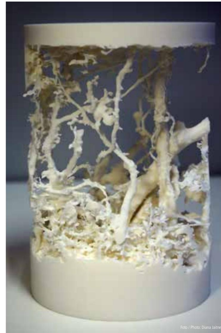
Abb. 3: 3-D-Druck eines filigranen Netzwerks von Makroporen aus einer Bodensäule im Grünland
